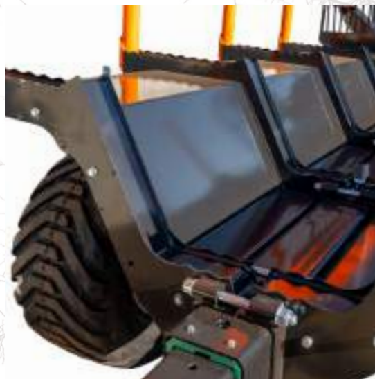
Lamiere di contenimento
