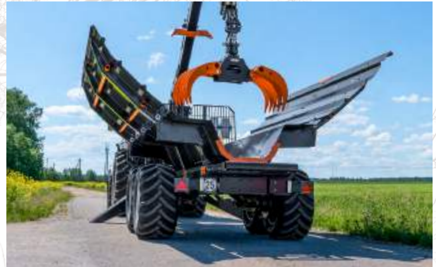
Cassone per biomassa a chiusura idraulica
